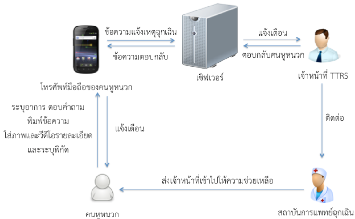
ภาพที่ 16 การแจ้งเหตุฉุกเฉินบนอุปกรณ์สื่อสารเคลื่อนที่ระบบปฏิบัติการ Android กรณีเชื่อมต่ออินเทอร์เน็ต
