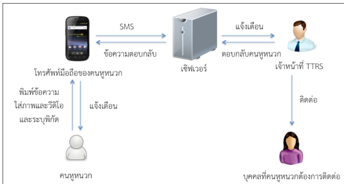
ภาพที่ 7 แผนผังบริการถ่ายทอดการสื่อสารแบบ SMS/MMS ผ่านโปรแกรมประยุกต์บนอุปกรณ์สื่อสารเคลื่อนที่
