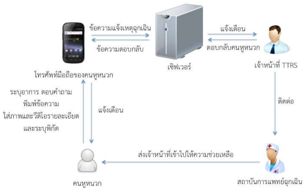
ภาพที่ 36 การแจ้งเหตุฉุกเฉินบนอุปกรณ์สื่อสารเคลื่อนที่ระบบปฏิบัติการ Android กรณีเชื่อมต่ออินเทอร์เน็ต
